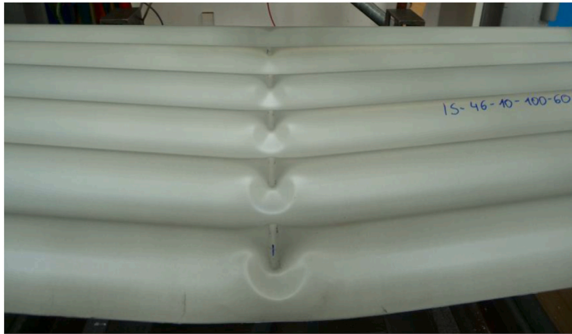
Fig. 14. Failure mode, IS-46-10-100-60-2.
