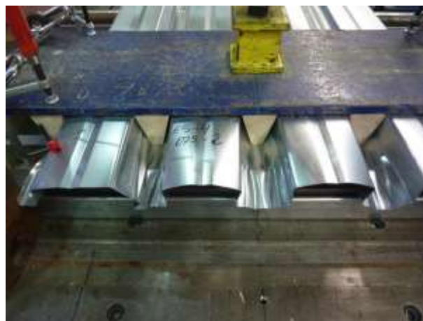
Figure 1.3.5 – Essai d'appui d'extrémité sur plaque nervurée non perforée
