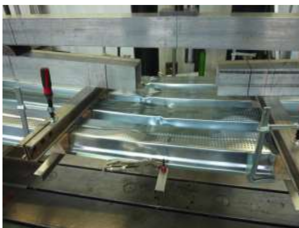
Figure 1.3.3 – – Essai en travée simple sur plaque nervurée perforée dans la semelle supérieure
