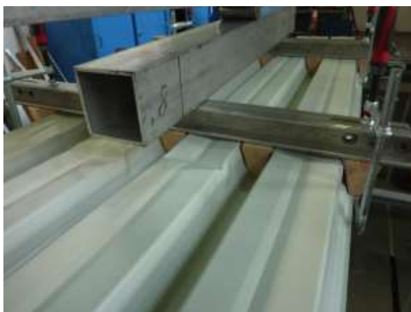
Figure 1.3.1 – Essai en travée simple sur plaque nervurée non perforée
