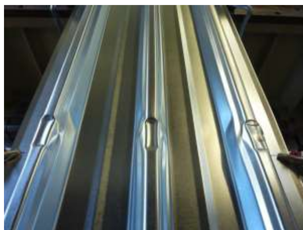
Figure 1.3.9 – Plaque nervurée non perforée après essai d'appui intérieur
