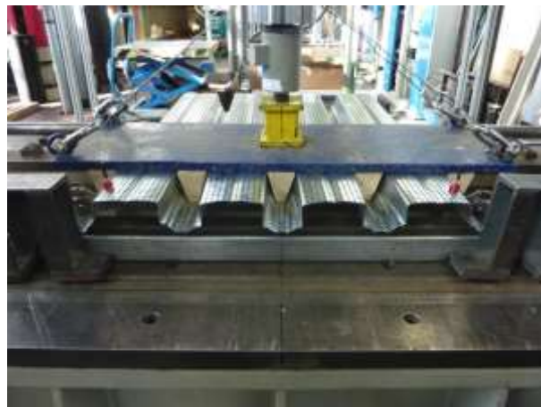
Figure 1.3.8 – Essai d'appui d'extrémité sur plaque nervurée non perforée
