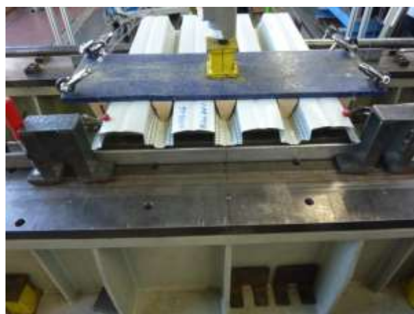
Figure 1.3.6 – Essai d'appui d'extrémité sur plaque nervurée perforée dans l'âme
