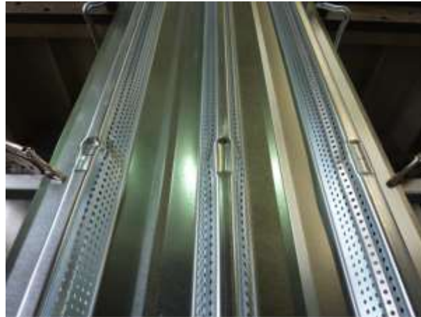
Figure 1.3.10 – Plaque nervurée perforée dans l'âme après essai d'appui intérieur
